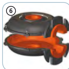
⑥ Korpus pompy (woluta) i wirnik pokryte grubą warstwą odpornej na ścieranie gumy Vulkollan
